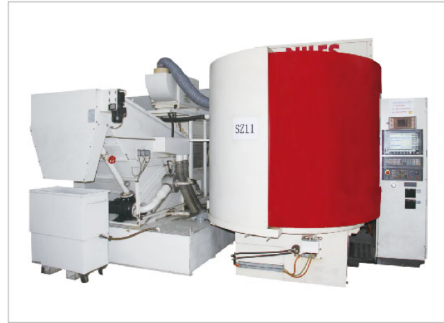
NILES-400磨齒機 精度可達到DIN3級
