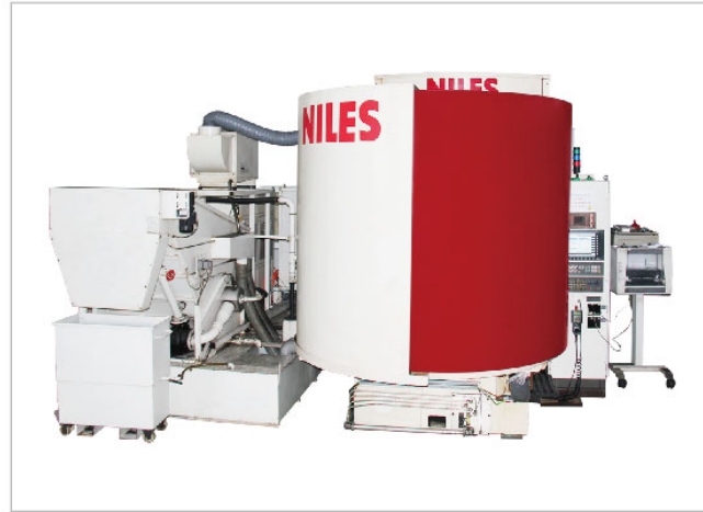
NILES-1200磨齒機 精度可達到DIN3級
